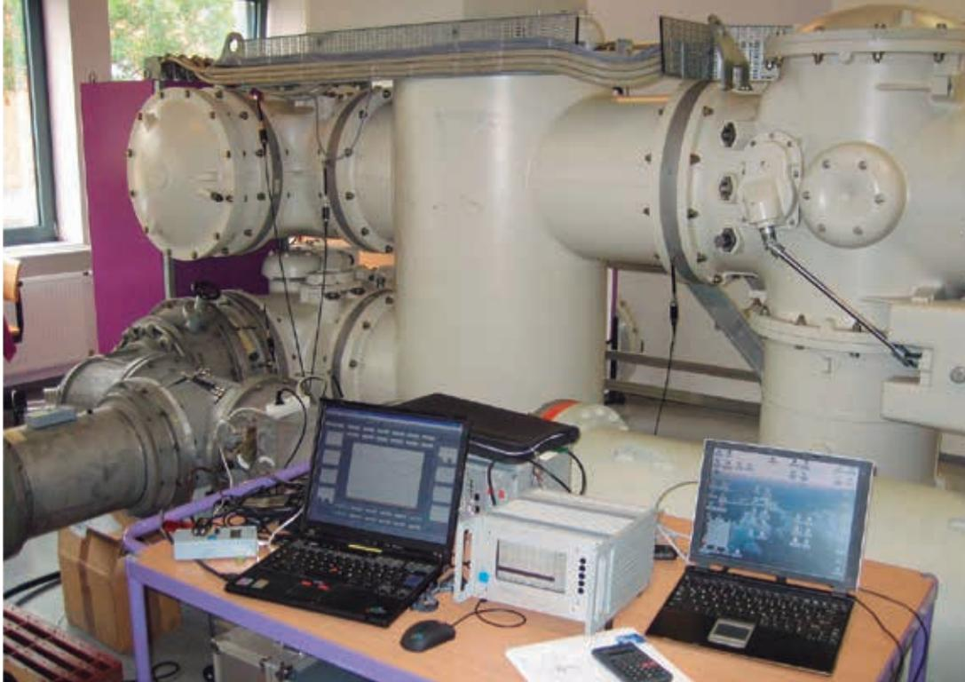
Ensayos en laboratorio de aparata eléctrica con aislamiento de gas (GIS, o *gas-insulated switchgear*).
