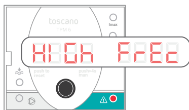
Frecuencia excesiva de arranques (>30 arranques/hora)
